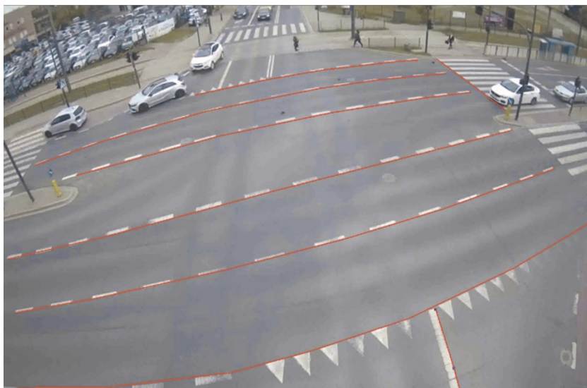
Ryc. 5. Klatka z naniesionymi liniami wyznaczającymi odcinki proste w terenie.
