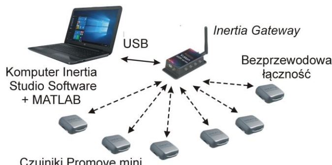
Rys. 1. Schemat układu ProMove mini
