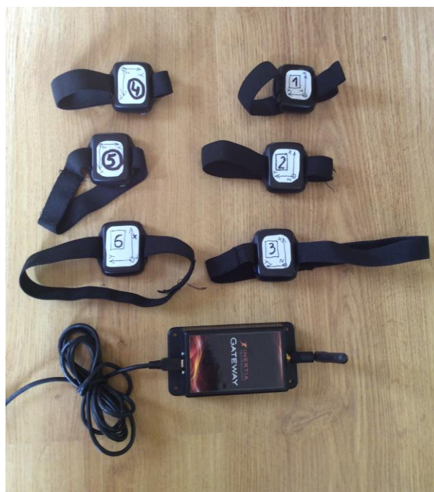
Rys. 1. Czujniki ProMove mini wykorzystane w eksperymencie
