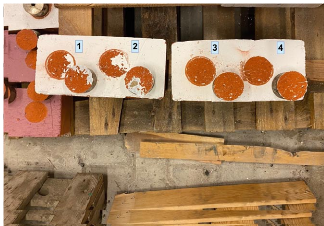
Rys. 1. StoColor Silco – próba oderwania na cegle [1]
