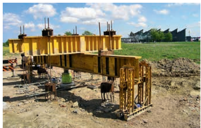
Ryc. 2. Pilotażowe próbné obciążenie statyczne
