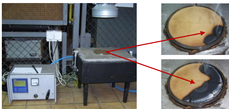
Rysunek 4.3.1. Stanowisko do oznaczania minimalnej temperatury zapłonu warstwy pyłu
