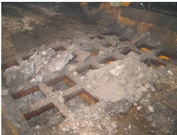
Rys. 5. Krata po oczyszczeniu automatycznym przez URB/ZS-3
