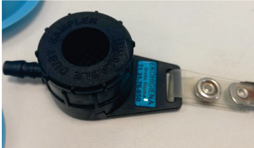
Fig. 5. Head for collecting inhaled fraction (photo K. Pikulik) Rys. 5. Głowica do pobierania frakcji wdychalnej (fot. K. Pikulik)
