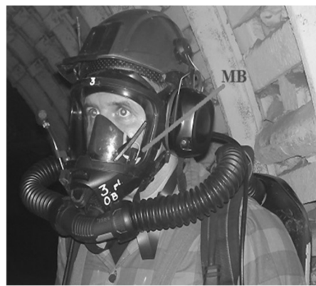
Rys. 3.7 Komunikator osobisty PC1.0 zainstalowany na helmie masce ratownika (pokazano lokalizację mikrofonu MB)
