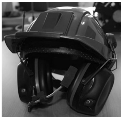
Rys. 3.6 Widok komunikatora osobistego PC1.0 ratownika
