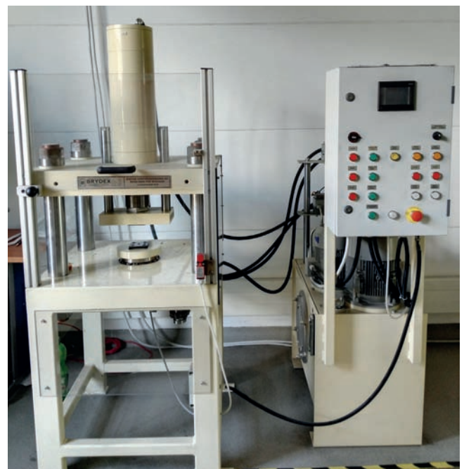
Rys. 8. Prasa hydrauliczna wraz z panelem sterującym
