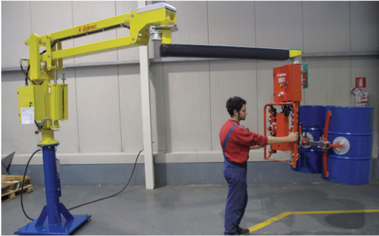
Rys. 3. Manipulator Dalmec o pneumatycznym układzie napędowym [17]
