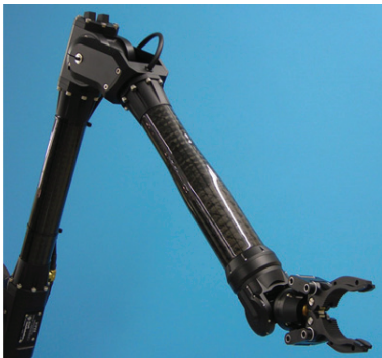
Rys. 2. Manipulator Viper Arm o elektrycznym układzie napędowym [16]
