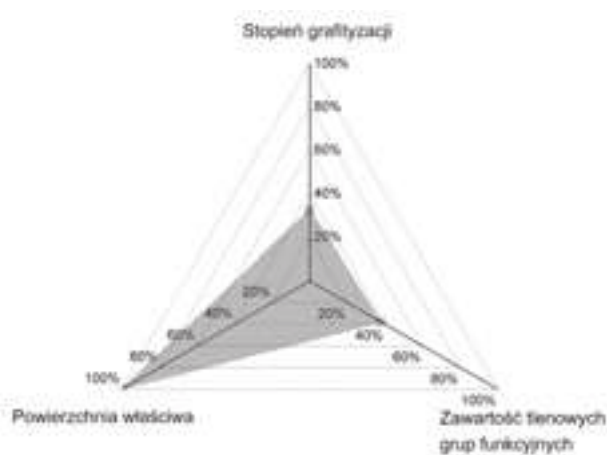
Rys. 6. Procentowy wpływ wybranych czynników na zmianę początkowej konwersji etylobenzenu w reakcji ODH prowadzonej w obecności różnych mezoporowatych katalizatorów węglowych
