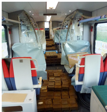
Rys. 3. Elektryczne zespoły trakcyjne obciążane balastem podczas badań właściwości trakcyjnych
