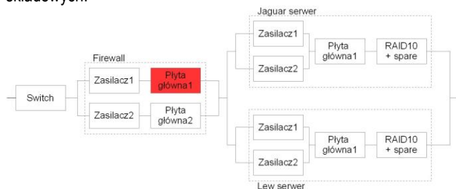
Rys. 3. Schemat zależności elementów serwera systemu sterowania ruchem.
