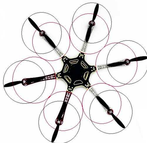
Rys. 1. Czarne okręgi – normalny zakres pracy łopat, czerwone okręgi – zakres pracy łopat przy zbyt dużym odkształceniu ramienia, powodującym uszkodzenie [8] Fig. 1. Black circles – normal working range blades, red circles – blades working range with too much arm deformation, causing damage [8]
