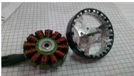
Rys. 1. Budowa silnika BLDC
