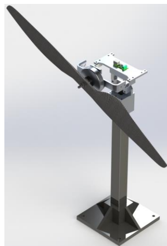
Rys. 2. Pojedynczy silnik ze śmigłem ciągnącym
