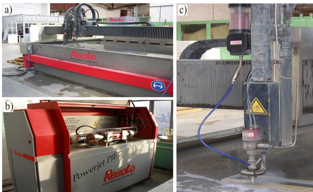
Rys. 1. Centrum obróbkowe AWJ typ RCT 32: a) widok ogólny, b) wzmacniacz ciśnienia, c) głowica tnąca Fig. 1. Abrasive water jet cutting center type RCT 32: a) general view, b) pressure intensifier, c) cutting head
