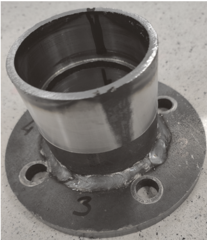
Rys. 10. Przykład spawanej tulei łożyskowej własnej produkcji
