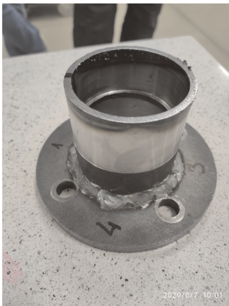
Rys. 5. Przykład spawanej tulei łożyskowej własnej produkcji
