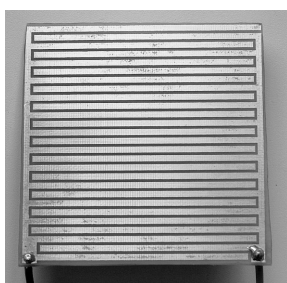
Rys. 1. Fizyczna realizacja elektrody I – grzebieniowej Fig. 1. Physical realization of electrode I – comb
