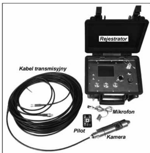
Rys. 4. Aparatura do badań introskopowych Fig. 4. The tools for intrascopic tests
