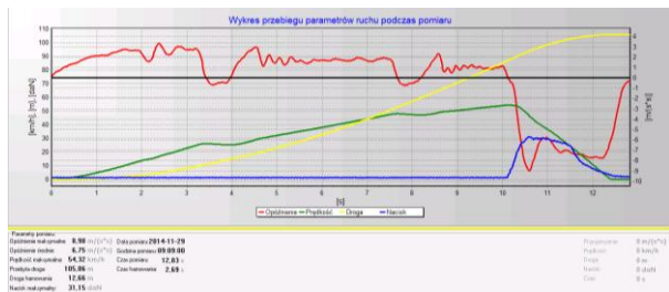
Rys. 8. Sprawny układ hamulcowy. Maksymalne opóźnienie hamowania 8,84 m/s 2 , wartość średniego rozwiniętego opóźnienia hamowania 6,95 m/s 2 , czas hamowania 2,7 s
