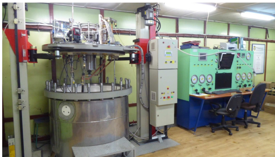
Rys. 2 Stanowisko połączonych symulatorów: oddechowego, metabolicznego i hiperbarycznego.
