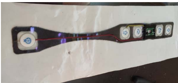
Rys. 2 Widok wymiennej Taśmy Pomiarowej (na podłożu taśmy Kinesio), z prawej strony zainstalowane cztery elektrody pomiarowe, z lewej elektroda referencyjna
