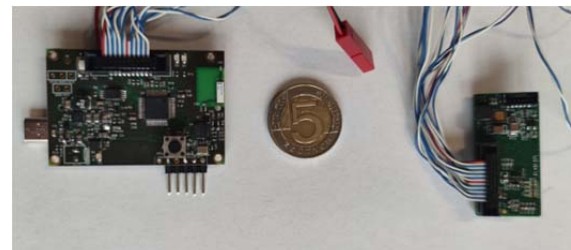
Rys. 4 Widok Modułu Akwizycji Danych bez obudowy (z lewej strony), w wariantcie drugim połączonym przewodami z Modułem Sensorów wpinanym w złącze na taśmie
