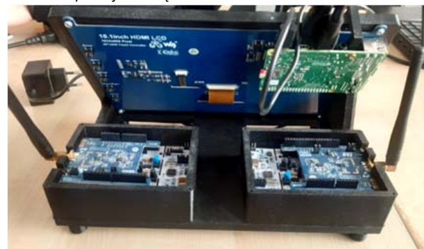
Rys.5 Widok Stacji Bazowej z otwartą obudową, z dwoma kanałami przesyłania danych drogą radiową (widoczne dwie anteny prętowe po bokach bloku) i układy łączy radiowych SPIRIT2. Po prawej stronie u góry widoczna płyta procesora Raspberry Pi, realizującego funkcje odbioru i przetwarzania danych oraz zarządzania funkcjonowaniem bloku
