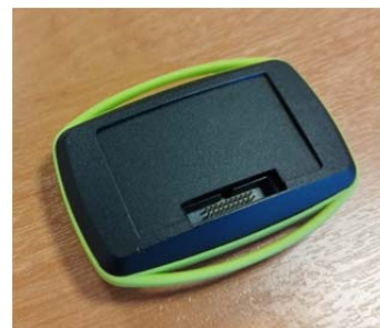
Rys. 3 Moduł MAD w obudowie do mocowania na taśmie elastycznej Kinesio na pacjencie (widoczne złącze do dołączania taśmy z przewodami z Modułu Sensorów. Wymiary obudowy ok. 50 x 70 x 15 mm, masa ok. 40g.
