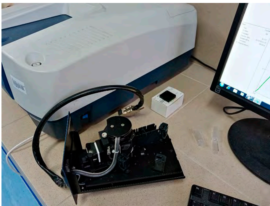
Fot. 1. Spektrofotometr UV-670 UV-VIS firmy Jasco z przystawką do pomiarów DRS wyjętą na zewnątrz (fot. IChTJ)
