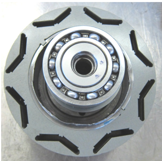
Rys. 1. Widok czółowy wirnika silnika MG2
