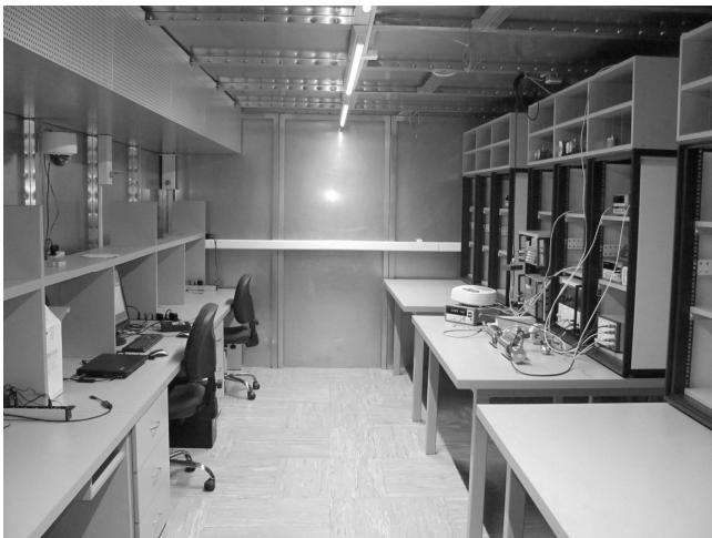
Rys. 1. Widok wnętrza elektromagnetycznie ekranowanej komory pomiarowej Laboratorium Wzorców AC-DC
