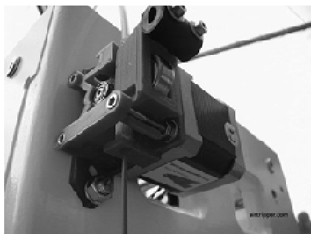
Rys. 7. Ekstruder Bowdena. Jest on przymocowany do obudowy drukarki – odciążamy w ten sposób karetkę z hotendem, lecz pojawiają się problemy z retrakcją – cofaniem filamentu
