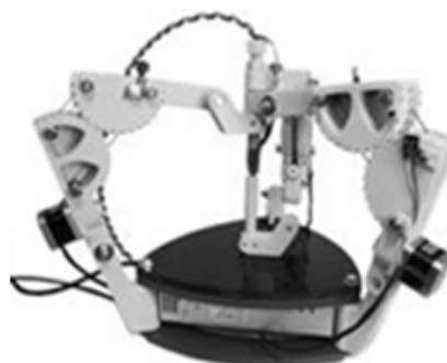
Rys. 4. Drukarka typu GUS - Żyłka owinięta wokół ramion i zaciskana lub popuszczana przez ruch silników krokowych porusza każdym z trzech, niezależnych od siebie ramion
