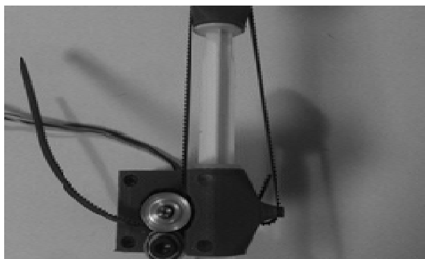
Rys. 6. Ekstruder do materiału w postaci masy. Pasek napędowy za pomocą silnika krokowego zostaje zaciskany wokół strzykawki powodując wyciskanie masy przez dyszę ekstrudera
