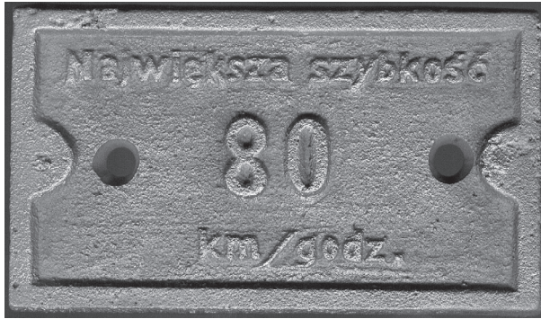
Fot. 29. Tabliczka szybkości konstrukcyjnej 30 Tabliczka szybkości konstrukcyjnej parowozu (80 km/h) Ty2-1177.
