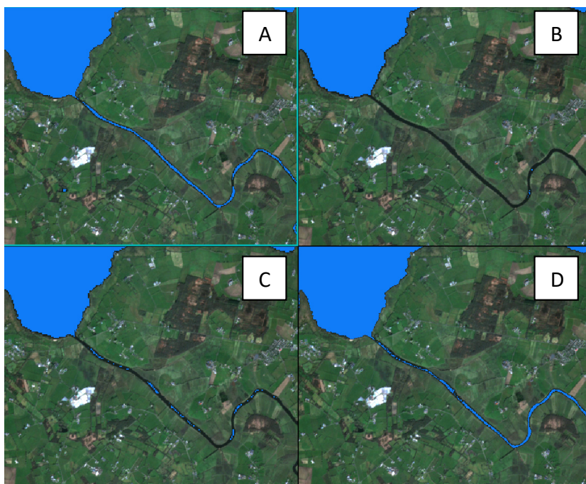
Ryc. 13. Detekcja wąskich cieków na podstawie wskaźników: A – SWM, B – AWEI_{nsh} , C – MNDWI, D – NDWI_{McFeeters} Fig. 13. The detection of narrow rivers using water indices: A – SWM, B – AWEI_{nsh} , C – MNDWI, D – NDWI_{McFeeters}
