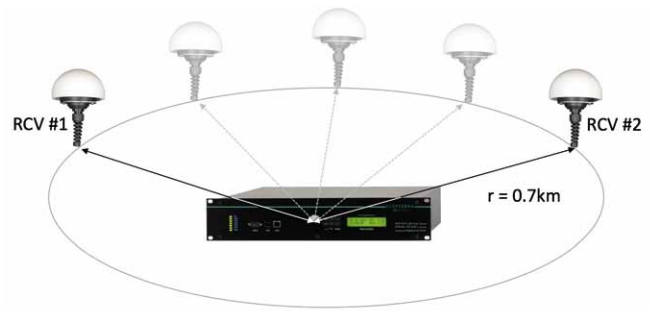
Rys. 14. Rozmieszczone w promieniu 0,7 km od serwera ELPROMA NTS-5000 dwa niezależne odbiorniki GNSS minimalizują skuteczność zagłuszania GNSS
