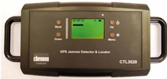
Rys. 16. Urządzenie rozpoznające zagłuszanie i wskazujące kierunek źródła
