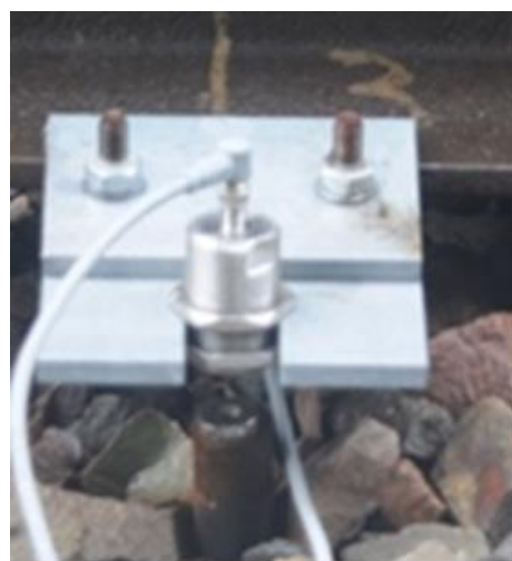
Fot. 5. Czujnik magneto-indukcyjny zamontowany w torze
