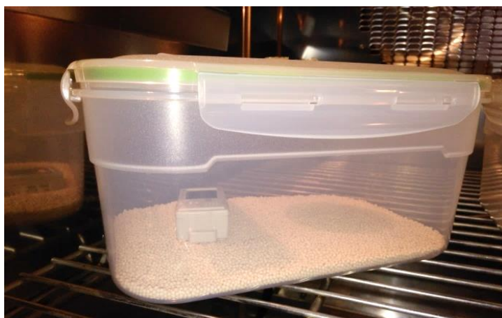
Rys. 13. Określenie minimalnego poziomu wilgotności względnej (RH). Umieszczenie absorbentu i termohigrometru w hermetycznym pojemniku
