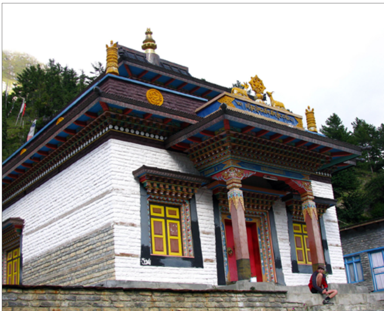
Fig. 15. Buddhist gumpa in Upper Pisang built using local rocks (gneiss, schist), photo J. Łach • Buddyjska gumpa w Upper Pisang zbudowana z wykorzystaniem miejscowego surowca skalnego (gnejsy, łupki), fot. J. Łach
