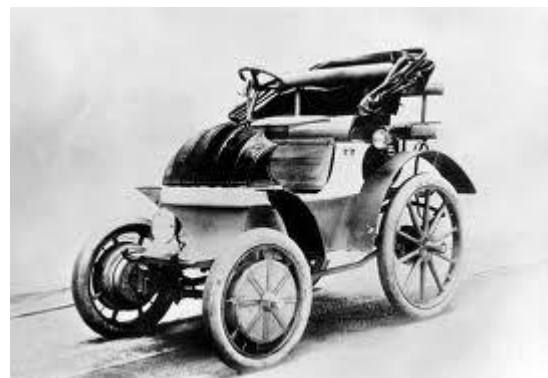
Rys. 1. Samochód Lohner-Porsche z silnikami elektrycznymi w kołach przednich [9]
