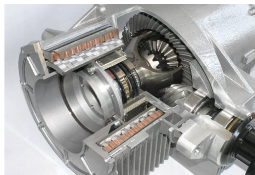
Rys. 6. Fragment mostu napędowego z mechanizmem różnicowym i jednym bocznym silnikiem elektrycznym połączonym z półosią
