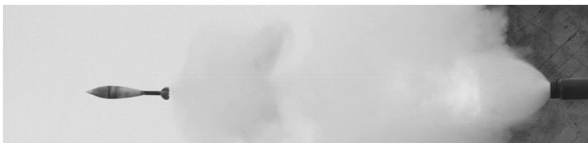
Rys. 4. Pocisk po opuszczeniu przewodu lufy w czasie strzału (fot. T.Merda)
