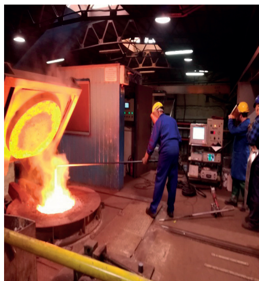
Rys. 2. Pomiar zawartości gazów w piecu topialnym Fig. 2. Measurement of gas content in a melting furnace
