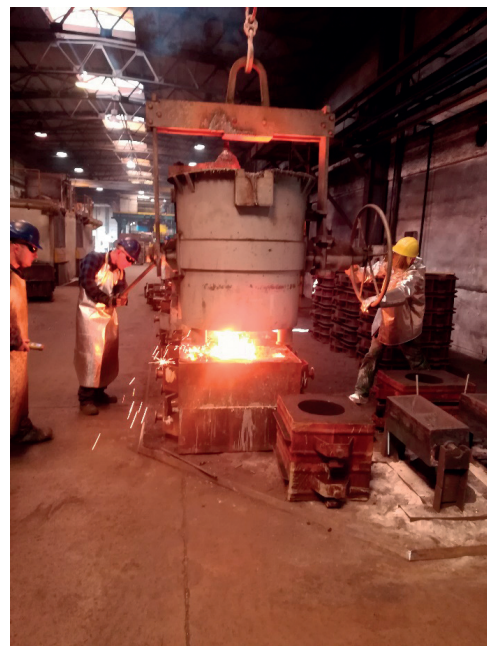
Rys. 6. Zalewanie form z kadzi zatyczkowej Fig. 6. Pouring of moulds from a stopper ladle
