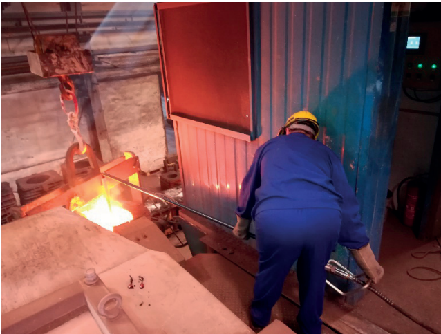
Rys. 3. Pomiar zawartości gazów w kadzi Fig. 3. Measurement of gas content in the ladle
