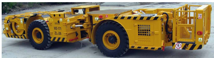
Wóz strzelniczy WS-171 (wysokość przejazdu: 1700 mm, wyposażony w podest koszowy o wysokości podnoszenia: 2200 mm)
