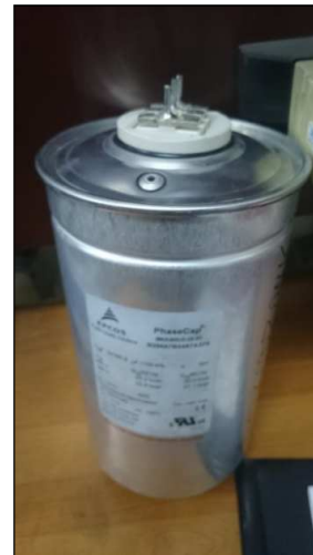
Rys. 7. Uszkodzony kondensator 25kVAr
