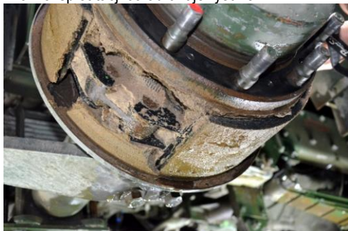
Rys. 1. Elementy wykonawcze układu hamulcowego pojazdu obiektu badań po ewakuacji z grząskiego terenu poligonu
