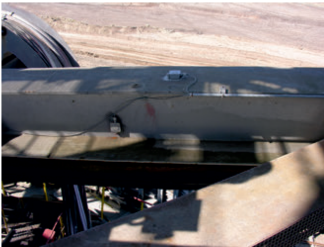
Rys. 5. Przykład rozmieszczenia tensometrycznych punktów pomiarowych
