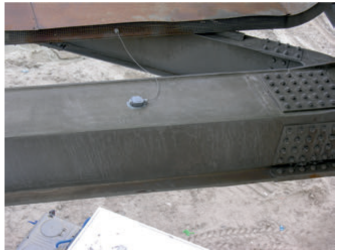
Rys. 7. Przykład rozmieszczenia tensometrycznych punktów pomiarowych
