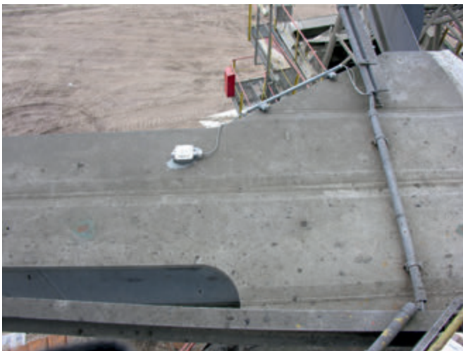
Rys. 6. Przykład rozmieszczenia tensometrycznych punktów pomiarowych
