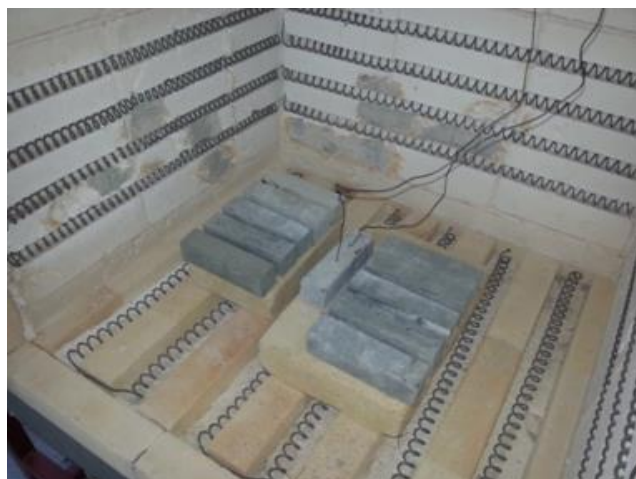
Rys. 4. Widok komory pieca z rozmieszczeniem próbek
