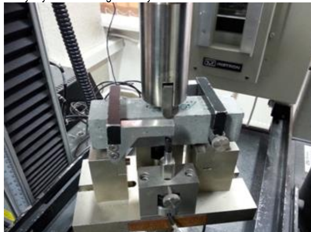
Rys. 6. Widok próbki podczas próby zginania
