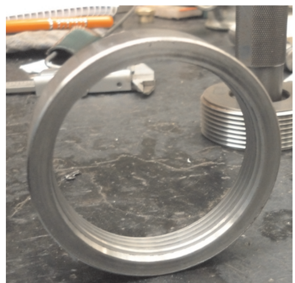
Rys. 10. Mufa z wykonanym gwintem
