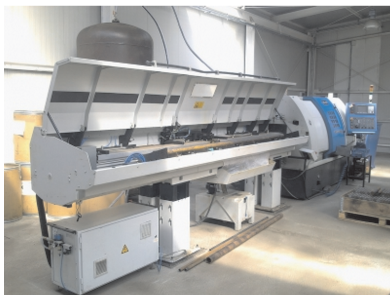
Rys. 9. Tokarka CNC z podajnikiem
