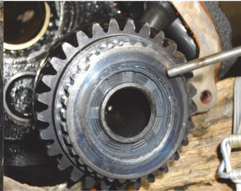
Fot. 3. Uszkodzenie łożyska wału odbioru mocy i zanieczyszczenie filtra hydrauliczki MF Photo 3. Bearing damage of the power take-off and pollution of hydraulic MT filter
