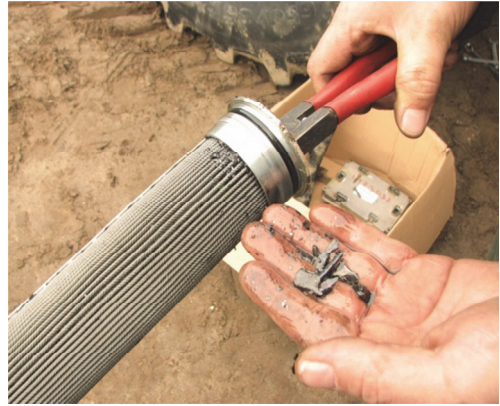
Fot. 3. Uszkodzenie łożyska wału odbioru mocy i zanieczyszczenie filtra hydrauliczki MF Photo 3. Bearing damage of the power take-off and pollution of hydraulic MT filter
