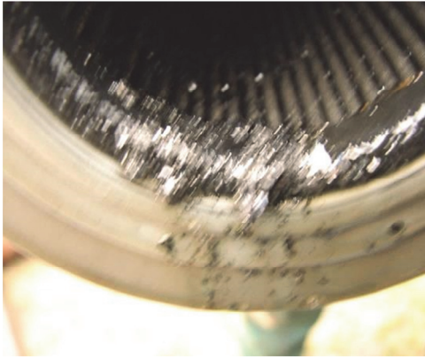
Fot. 2. Zatrzymanie opiłków po stronie wewnętrznej filtra – opiłki pochodzą z uszkodzonego łożyska Photo 2. Stop iron fillings inside the filter – fillings originate from a damaged bearing
