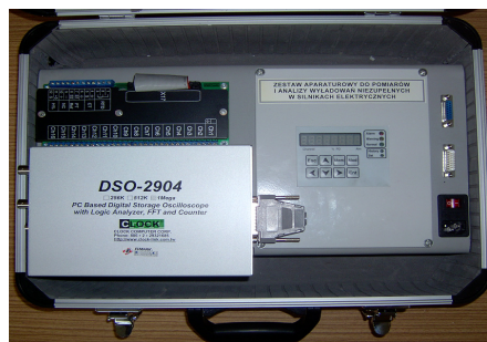
Rys. 12. Przenośny zestaw aparaturowy do pomiarów i analizy wnz w silnikach elektrycznych produkcji własnej
