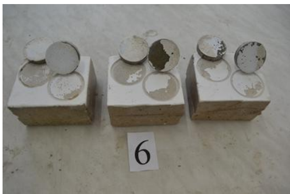
Rys. 7. Typy zniszczenia na przykładzie próbek F6 Fig. 7. Failure patterns obtained for samples F6
