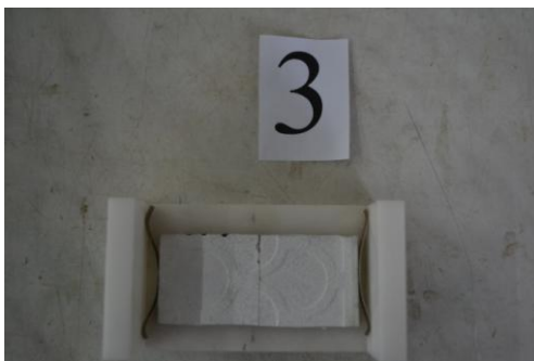
Rys. 6. Urządzenie do wykonywania rys zastosowane w badaniach Fig. 6. Device used in the tests for performing the cracks
