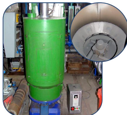
Rys. 1. Widok zewnętrzny regeneratora mechanicznego wirnikowego zaprojektowanego na Wydziale Odlewnictwa AGH wraz z wewnętrznym systemem elementów ścierających
