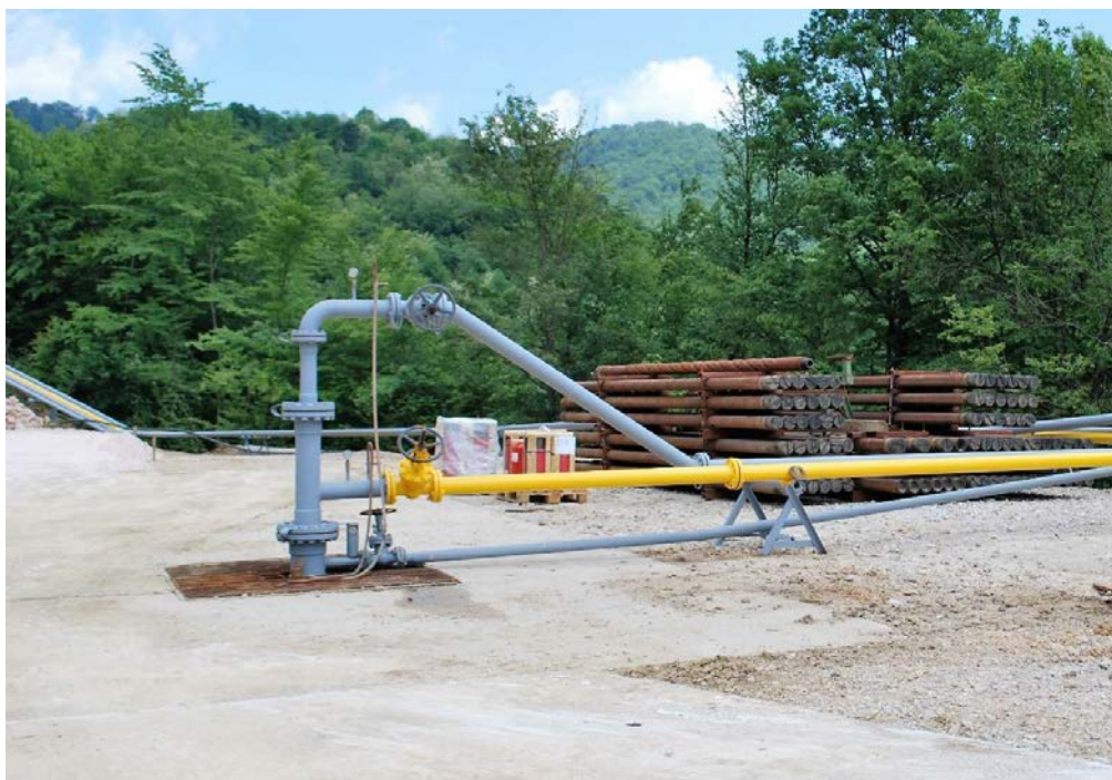
Ryc. 4. Głowica ługownicza na złożu soli kamiennej Tetima Fig. 4. Solution mining wellhead at Tetima salt deposit
