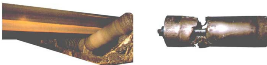
Rys. 2. Skutki nadmiernego zukosowania bocznego krążnika centrującego (Furmanik, Jabłoński, 2002)
