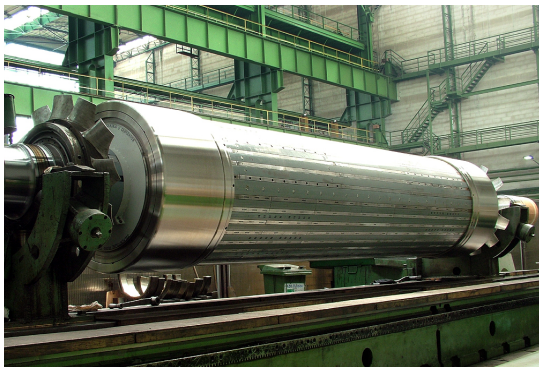
Rys. 9. Zmodernizowany wirnik turbogenera- tora TGH-120 [8]
