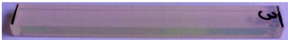
Rys. 2. Geometria próbki – badania chłonności Fig. 2. Specimen geometry – investigation of water absorption
