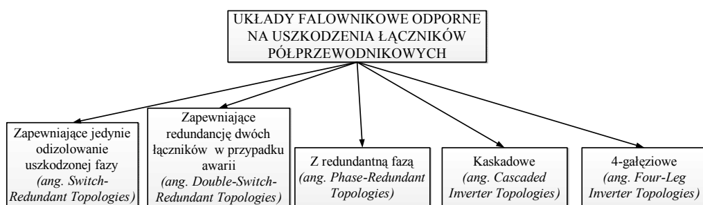
Rys. 3. Klasyfikacja układów falownikowych odpornych na uszkodzenia łączników
